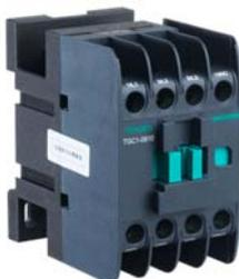
Контакторы переменного тока серии TGC1 (далее контакторы) отличаются современным внешним видом и небольшими габаритными размерами. Применяются в электрических сетях с номинальным рабочим напряжением до 690VAC с частотой 50/60Hz. Данные контакторы предназначены для частого дистанционного пуска и останова электродвигателей категорий AC-3, AC-4, а также могут работать в паре с тепловым реле для защиты электродвигателя от перегрузки.
