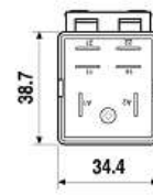
Адаптер 35 мм рейки (EN 60715) для реле типов 65.31.xxxx.xxx9
